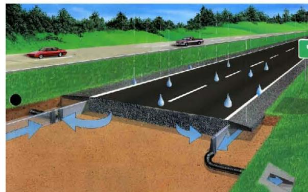
雨水垂直通过OGFC到达不渗水的下卧层表面，然后从侧向排到路面的边缘。运用排水降噪路面系统构筑节约型园林绿化，既减小了城市污水管道压力，又减少了绿化灌溉用水量，可形成自然生态平衡的小区。
